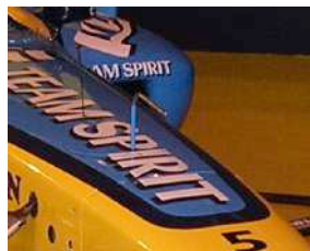
tube de Pitot montée sur la voiture de formule 1 Renault de Fernando Alonso (2005)
