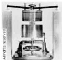
Le viscosimètre construit et utilisé par Maurice Couette pour mesurer la viscosité de l'eau et de l'air en 1888
