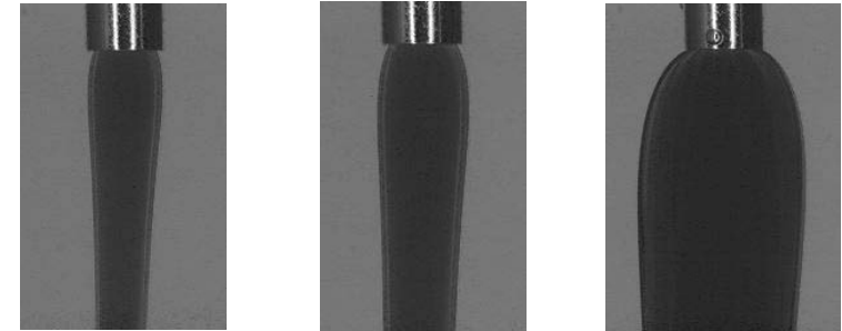
FIGURE 1.27 – Ecoulement d’un fluide visco-élastique à la sortie d’un tube cylindrique. Les photos montrent le gonflement progressif du jet à la sortie d’un tube lorsque le taux de cisaillement augmente (de gauche à droite : \dot{\epsilon} = 24 puis 60 puis 240 s^{-1} ). Ce gonflement met en évidence l’existence de contraintes normales dans ce fluide. (Photos L. Pauchard, FAST Orsay.)
