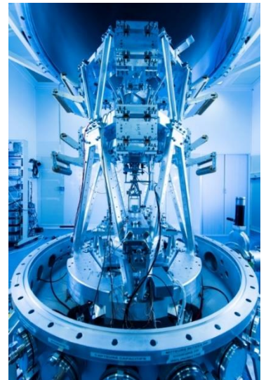
Balance du watt du LNE utilisée pour produire la valeur de de la constante de Planck, h
