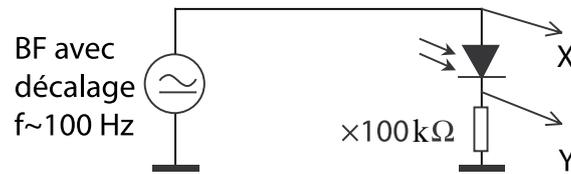
FIGURE 1 – Montage de la photodiode pour la caractéristique courant-tension (utiliser une résistance de l'ordre de  $100k\Omega$ )
